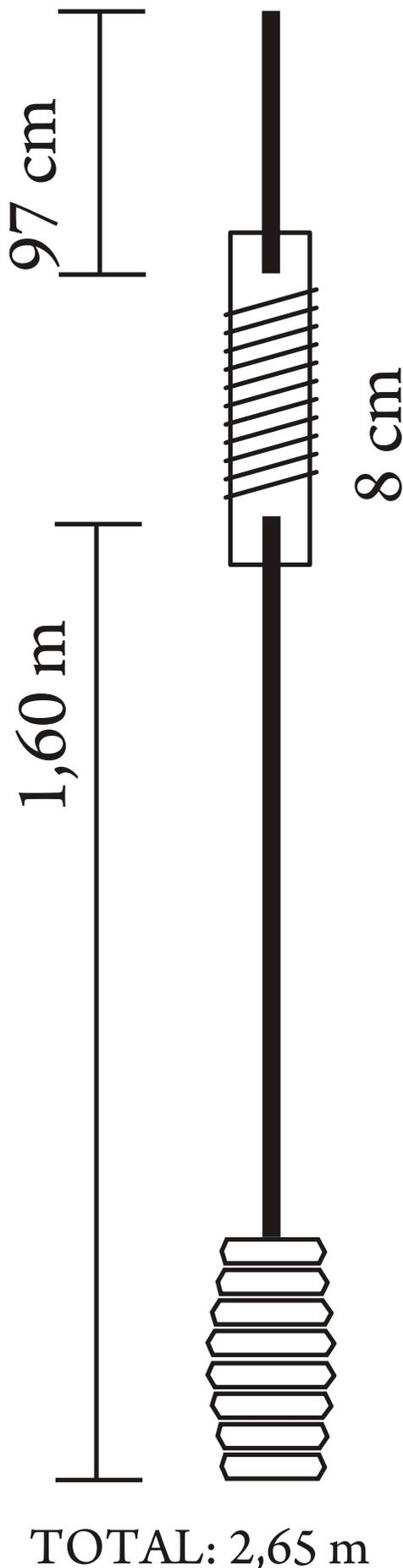
Como o diâmetro da bobina é bem maior que um caninho de PVC, pode-se fazer um molde de papelão, enrolar a bobina e fixá-la com alguma cola plástica, como Araldite. Depois de seca, retire o papelão e você terá uma bobina larga, que poderá ter as extremidades soldadas ou seguras por abraçadeiras de rosca.
