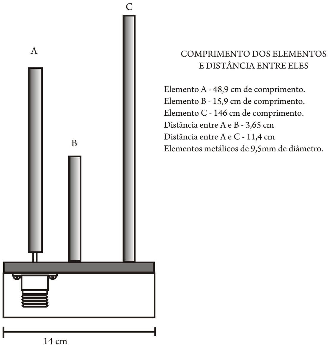
Sugestão de como construir a antena, usando uma cantoneira metálica. Repare que o elemento irradiante é isolado da cantoneira. Se usar conector coaxial fêmea (para VHF/UHF), o irradiante é ligado só no furo central, senão ficaria em curto com os demais elementos. Não há problema da cantoneira ser aterrada através de um mastro metálico.
