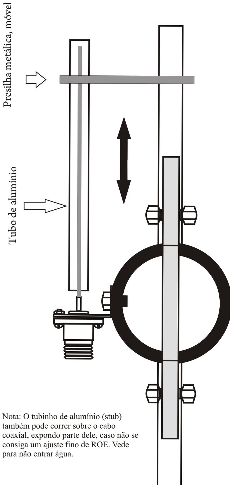
Nota: O tubinho de alumínio (stub) também pode correr sobre o cabo coaxial, expondo parte dele, caso não se consiga um ajuste fino de ROE. Vede para não entrar água.
