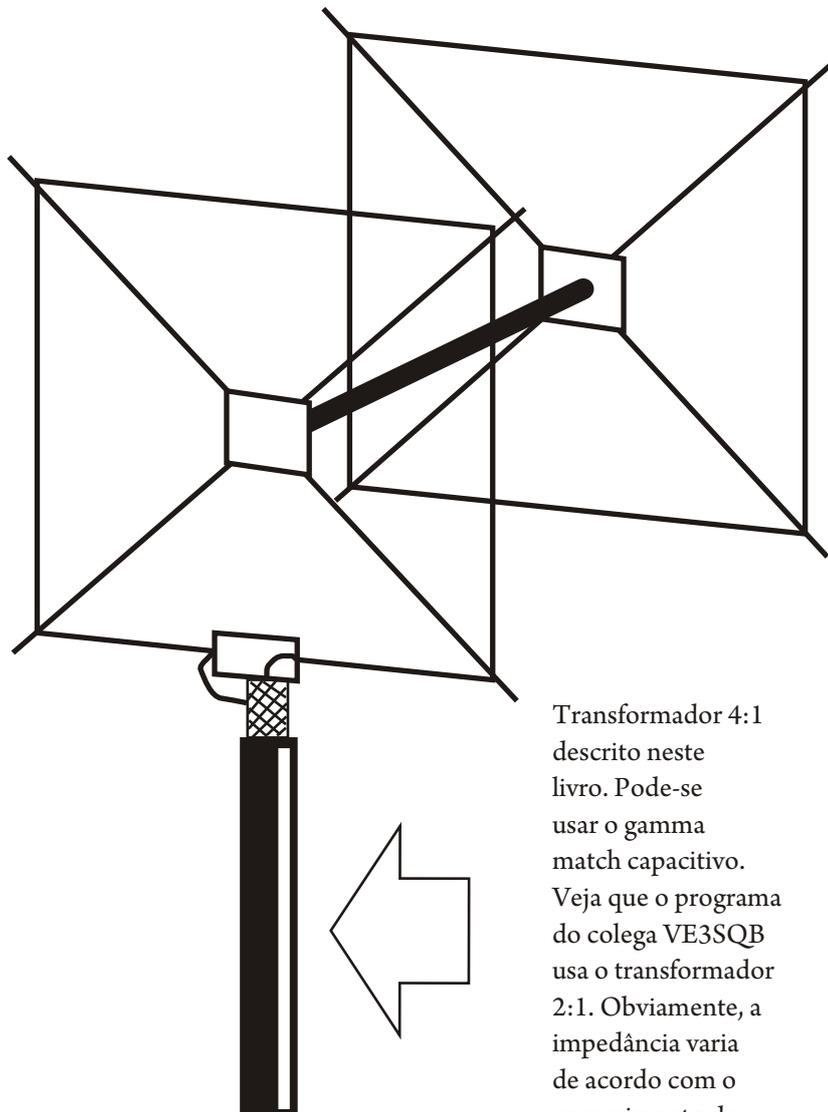
Transformador 4:1 descrito neste livro. Pode-se usar o gamma match capacitivo. Veja que o programa do colega VE3SQB usa o transformador 2:1. Obviamente, a impedância varia de acordo com o comprimento da gôndola e o número de elementos, por isso, não é um valor fixo, conforme mostramos neste livro!
