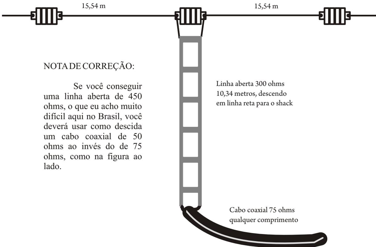
O Galieno Lobato deu uma interessante dica para quem usar a fita de TV de 300  $\Omega$ : fazer furos no centro da fita, com o cuidado extremo de não se interromper os condutores. Isso faz com que a fita fique o mais próximo possível de uma linha aberta, já que o material plástico, que funciona como dielétrico, será bem reduzido.
