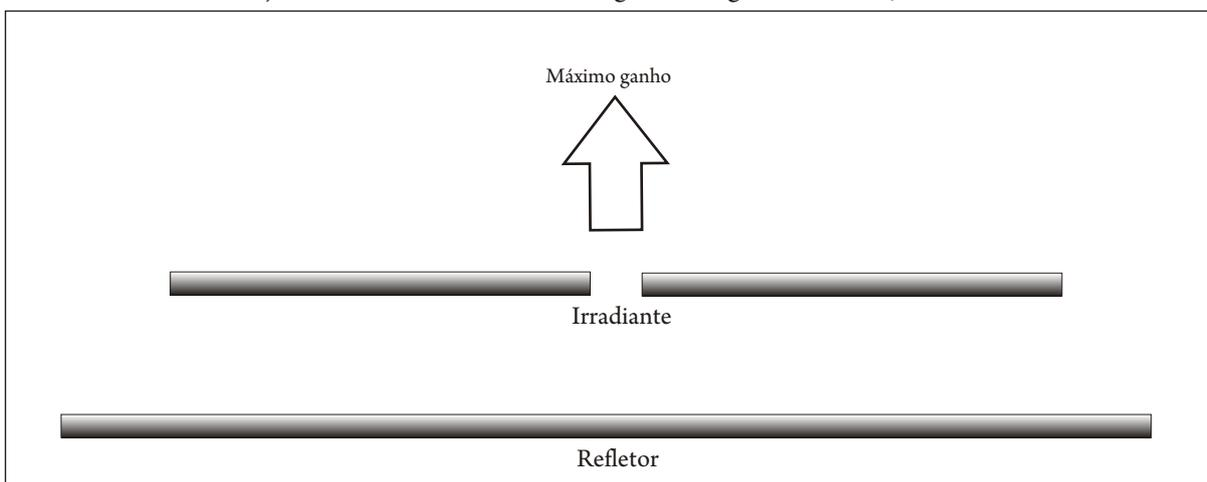
Esta é a diferença: O irradiante sempre leva o cabo coaxial. O elemento parasita quando é maior que o irradiante, este é o refletor. Quando leva um elemento parasita menor que o irradiante, ele é chamado de diretor. Pode ter vários diretores, mas quase sempre um único refletor! Como uma seta, a antena sempre irradia na direção do elemento menor. Se usar apenas dois elementos, o irradiante será sempre o maior
