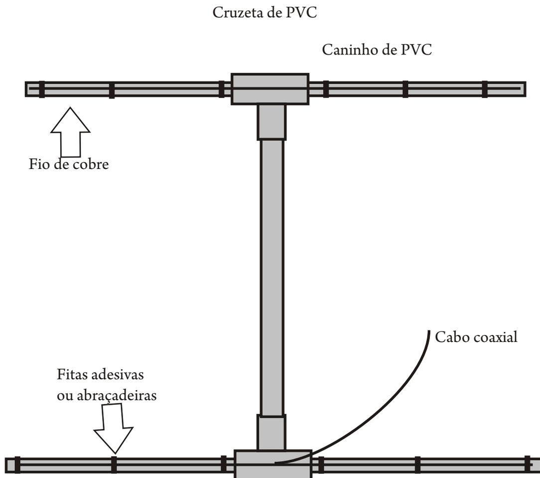
Abaixo, detalhes para a montagem do gamma-match. O tubo de alumínio que recebe o condutor central do cabo coaxial, costuma ter meia polegada de diâmetro. Este tipo de gamma-match também serve para antena Quadra Cúbica, mas o comprimento dos elementos é bem maior e há uma sutil diferença em sua construção.
