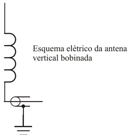
Nota: a matemática envolvida em antenas encurtadas para uso móvel é a mesma aplicada às antenas encurtadas dipolo, conforme aparece neste livro. Procure a tabela de indutâncias no ARRL Handbook e você terá todos os detalhes para a confecção da bobina, como diâmetro do fio, comprimento do enrolamento, número de espiras e, o que é mais importante, a *indutância* da bobina em microhenries.
