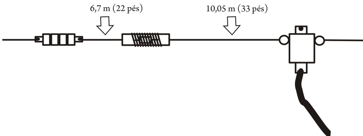
Detalhes da construção da bobina. O capacitor fica no interior do tubo de PVC, soldado entre as duas extremidades do enrolamento. Ao final, usa-se um tubo de maior diâmetro, “encapando” todo o conjunto. Pode-se usar um verniz resistente às intempéries. Atenção: Deve-se usar o corpo do PVC ou um isolador no centro para sustentar a bobina, caso contrário, o capacitor vai romper!
