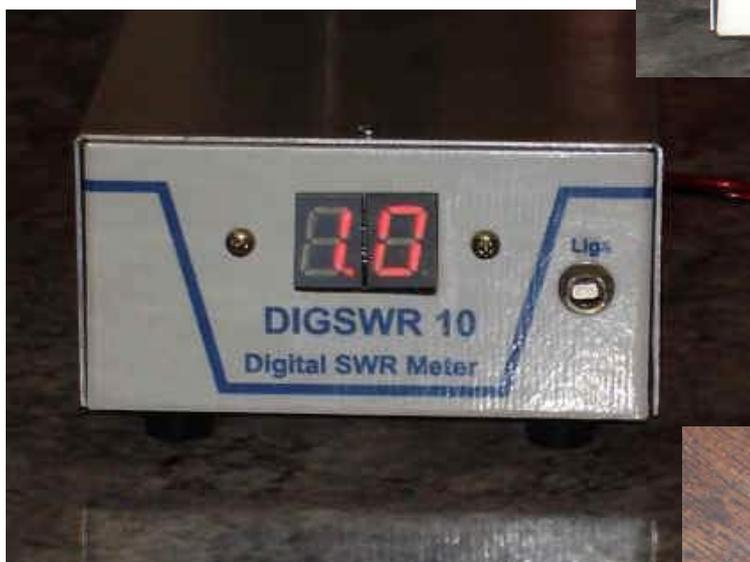
Acima, medidor de ROE montado
