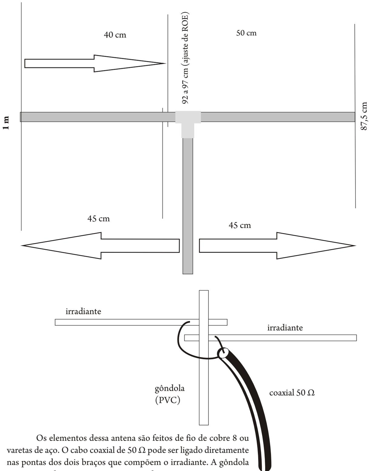
Os elementos dessa antena são feitos de fio de cobre 8 ou varetas de aço. O cabo coaxial de 50  $\Omega$  pode ser ligado diretamente nas pontas dos dois braços que compõem o irradiante. A gôndola tem 1 metro de comprimento, aproximadamente.
