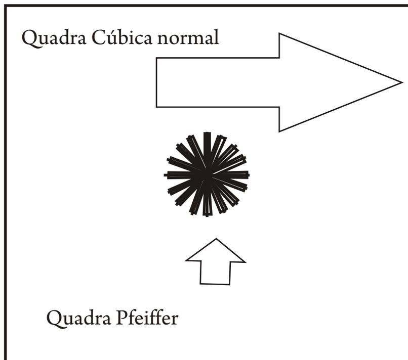
Relação entre o tamanho final de uma quadra normal para 40 metros e uma quadra Pfeiffer. Uma observação importante: o perímetro do fio (comprimento total do fio) é maior que numa quadra ou loop comum. Vale à pena experimentar, pelo tamanho. O autor garante que não há perda de eficiência da antena, apesar de seu reduzido tamanho.
