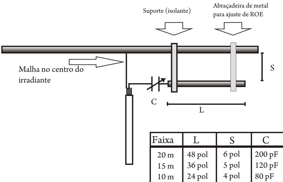
Acima, o sistema mais comum, adotado para acoplamento de uma antena Yagi-Uda, de dois ou mais elementos. Como dito anteriormente neste livro, se você tiver uma idéia de qual a impedância apresentada, você poderia usar o cabo coaxial de  $75 \Omega$  como transformador. A vantagem do gamma-match é o ajuste preciso para a menor ROE, o que pode não acontecer com o transformador coaxial já cortado.
