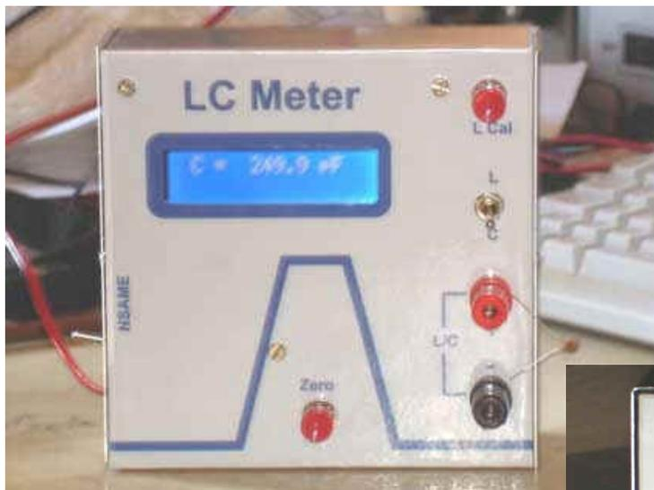
Medidor de indutâncias e capacitômetro digital, indispensável nas montagens de transceptores.
