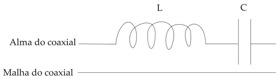
A antena na verdade é um circuito LC sintonizado, conforme mostra seu diagrama elétrico. Este modelo de antena é divulgado pelo colega francês F5-IXU e não deixa de ser “aparentada” da polêmica antena EH.
