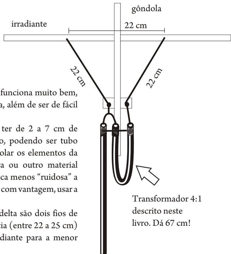
Esta é uma antena clássica e funciona muito bem, conforme já comprovamos na prática, além de ser de fácil montagem.
