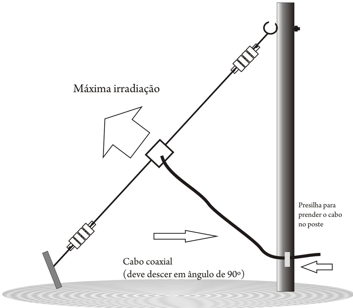
Na figura acima, um típico dipolo de meia-onda, inclinada, para DX
