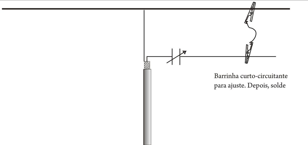
Desenho elétrico de um gamma-match. O capacitor pode ser variável ou feito a partir de um tubo de alumínio com a parte central do cabo coaxial (mais comum). Este é próprio para Quadra Cúbica, onde o fio central vai ligado ao capacitor e este, ao irradiante através de um pedaço de fio
