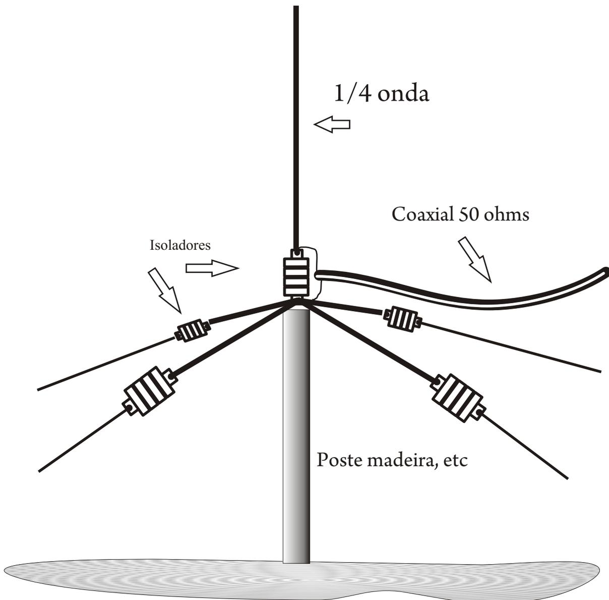
Quatro radiais inclinados a  $45^\circ$  de  $1/4$  onda cada um. Veja que os radiais estão ligados entre si e à malha do coaxial e isolados do elemento irradiante (vertical).
