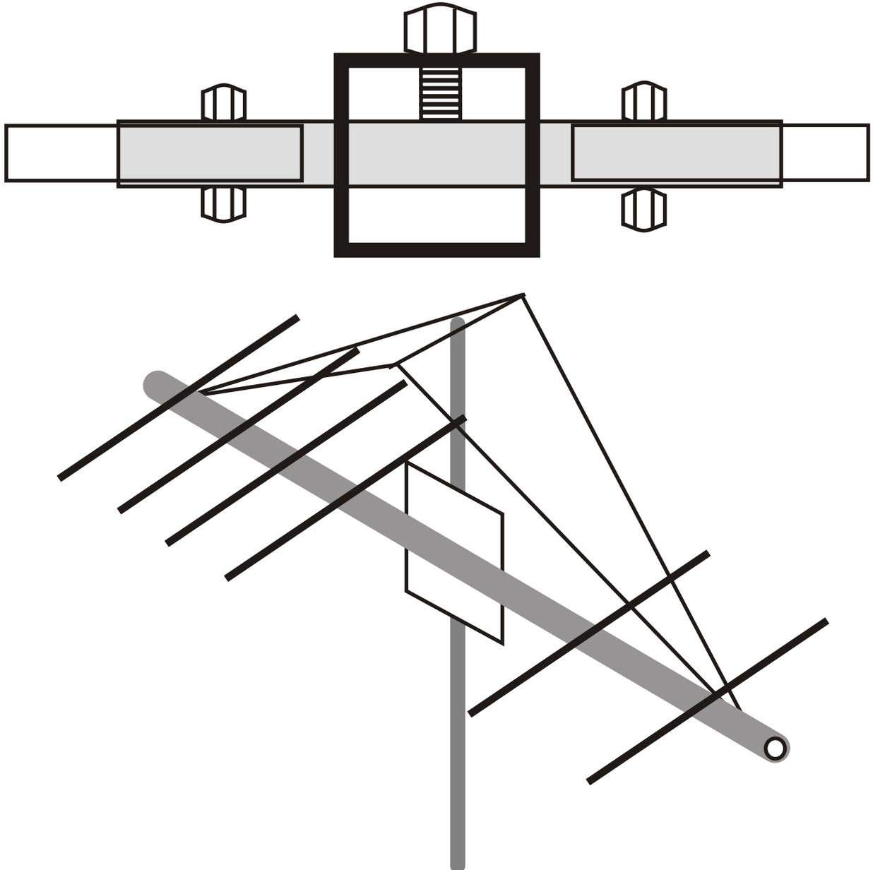
O desenho não está em escala, mas é bom usar um estai de corda de nylon. Até mesmo elementos de grande comprimento, como no caso de Yagi monobanda para 40 ou 20 metros, podem levar um estai, evitando que envergue muito ou quebre, já que os tubos de alumínio comuns tem um ponto de ruptura bem inferior aos tubos de duralumínio (liga composta com outros metais duros).
