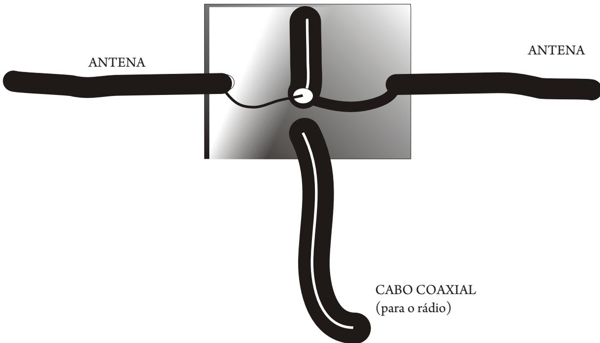
Neste caso, observe que o cabo coaxial entra pelo furo inferior, passa para a parte de trás e entra novamente pelo furo superior, ficando de “cabeça-para-baixo”, evitando a entrada de água. Muitos preferem usar uma bolinha de silicone para vedar a ponta do cabo coaxial, mas é arriscado a se soltar e entrar água no cabo, danificando-o ou, no mínimo, alterando suas características elétricas.
